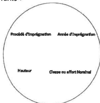
Figure 2 - Marquage sur poteau bois
